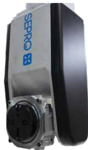
La línea 5X es una gama de robots industriales de 5 ejes flexibles y de alto rendimiento con servo rotaciones de muñeca diseñados por Sepro
